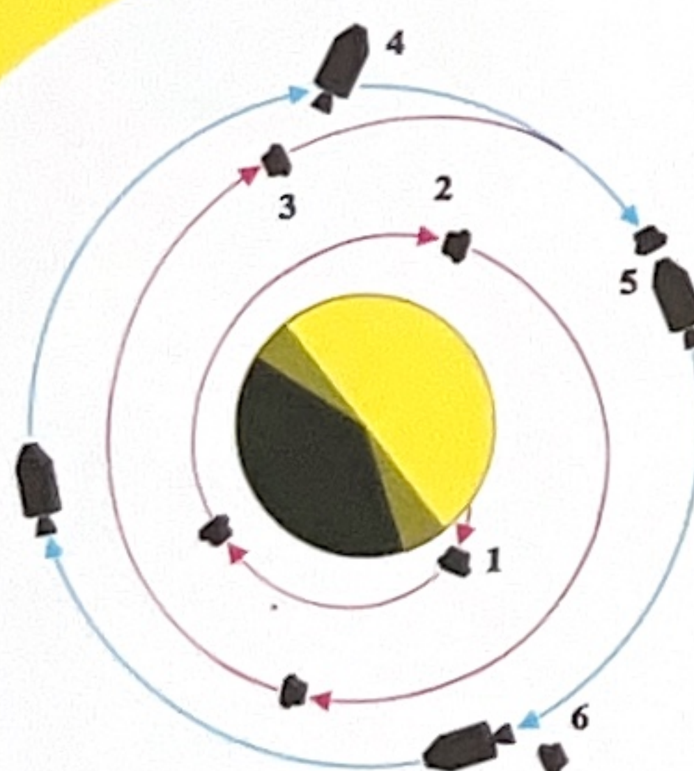
1. Start. 2. In baan onder die van het moederschip. 3. In parkeerbaan van het moederschip. 4. Moederschip wordt omge- keerd voor koppeling met LEM. 5. Rendez- vous. 6. LEM wordt afgestoten.
